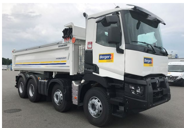
Camion de chantier 6x4, 8x4 (livraison de la GNT)
